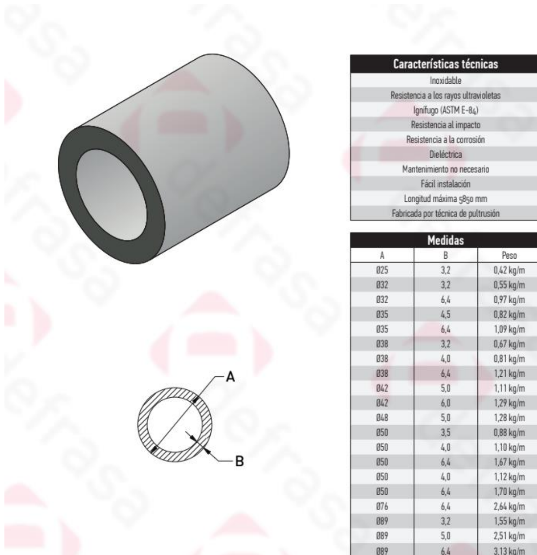
Figura 4.11. Característiques i mesures PRFV per Defrasa (veure [10])
