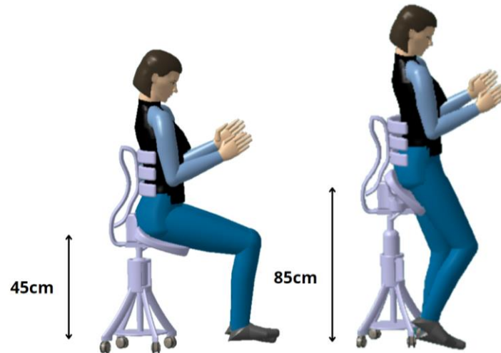
Figura 53: Dos posiciones de elevación del exoesqueleto
