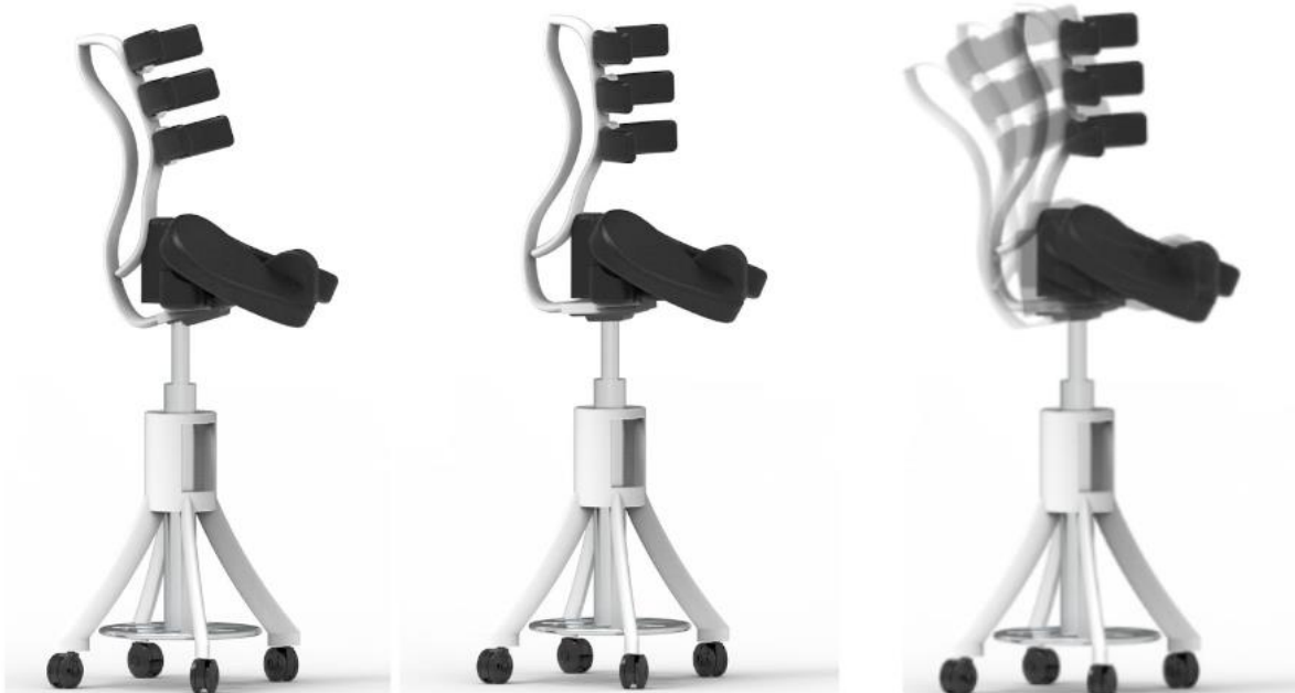
Figura 63: Esquema diferentes posiciones del respaldo del exoesqueleto
