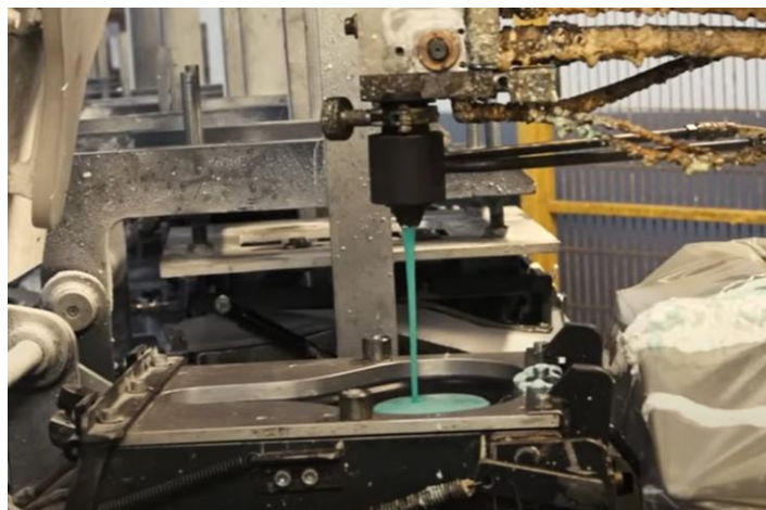
Figura 128: Inyección plástico para sillón
