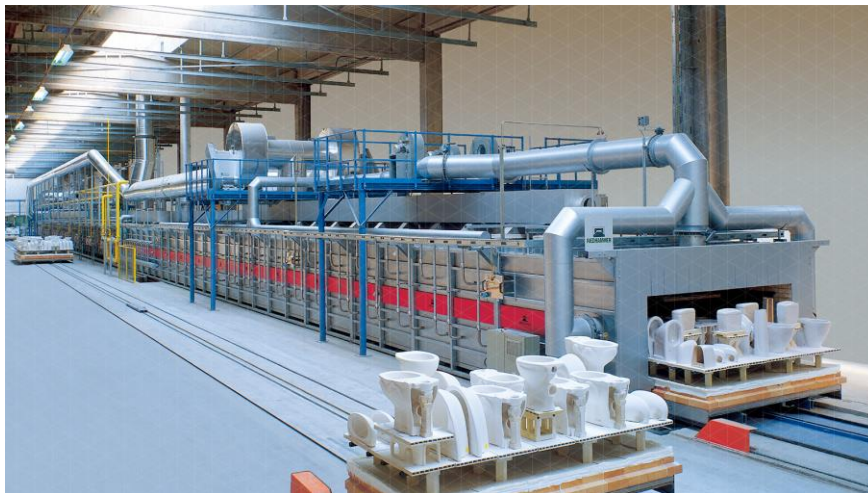
Figura 155: Túnel de cocción de cerámica
