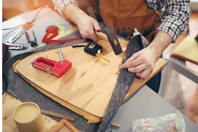
Figura 152: Forraje de estructura de madera
