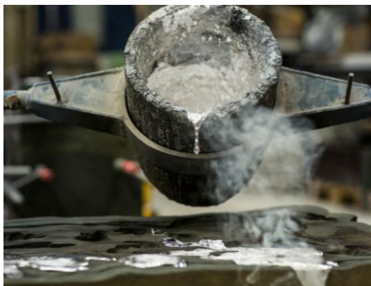
Figura 163: Refundido aluminio para reciclaje
