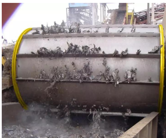
Figura 162: Separadores magnéticos reciclaje de aluminio
