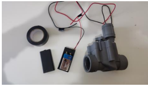
FIGURA 37 Sistema de tir muntatge
