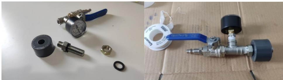
FIGURA 41 Sistema de càrrega d'aire 2
