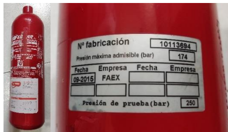
FIGURA 48 Extintor com a tanc
