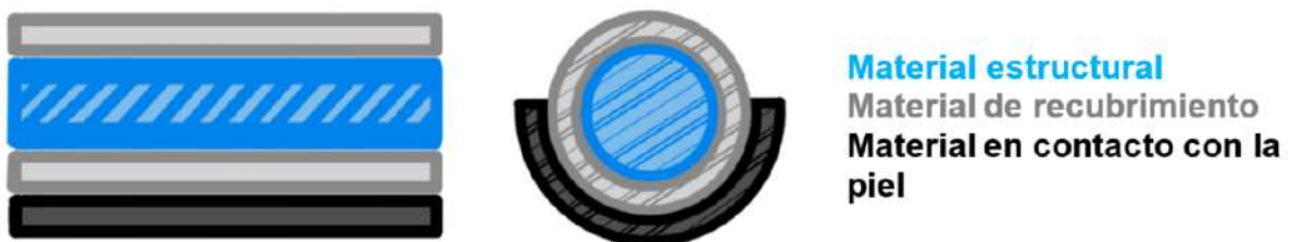
Figura 36. Vista de corte del producto. Distinción de materiales
