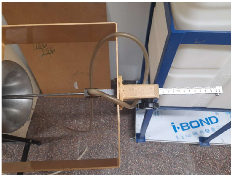
Ilustración 4.3. Ajuste piezométrico para poder regular la posición de la medida de presión (Fuente: Alejandro Lopez-Tello)
