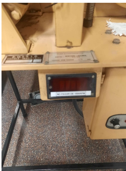
Ilustración 4.8. Display donde se mide la velocidad de giro del ventilador (Fuente: Alejandro Lopez-Tello)
