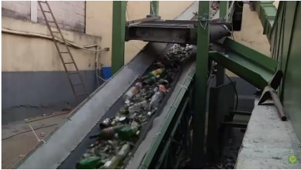
1. Separación de impurezas como tapas, derivados cerámicos, metales o plásticos.
