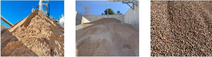
Arena, garbancillo y grava mixtos reciclados. HERCAL ECO-CONCRETE
