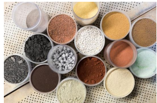
RCD pulverizados, StoneCycling
