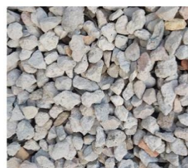
Arena, garbancillo y grava reciclados. HERCAL ECO-CONCRETE
