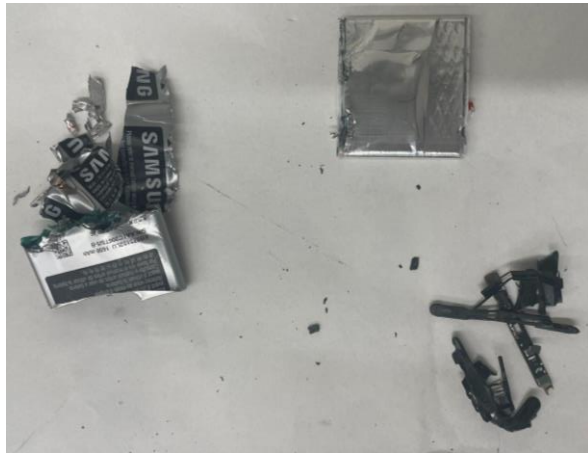
Figura 13: A la part esquerra la carcassa externa, part dreta les tapes superiors i inferiors, i al centre embolcall de plàstic
