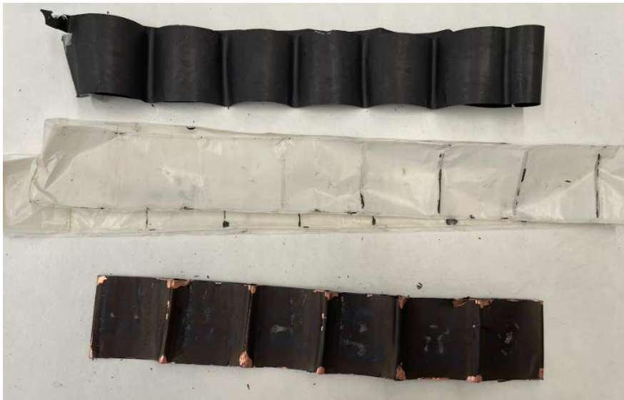
Figura 14: Components presents dins l'embolcall de plàstic. De dalt a baix, ànode, separador i càtode.
