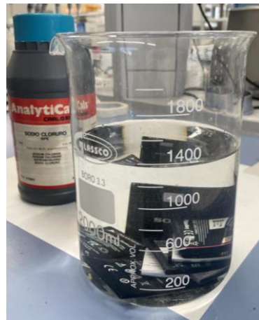
Figura 11: Bateries submergides en una solució de NaCl
