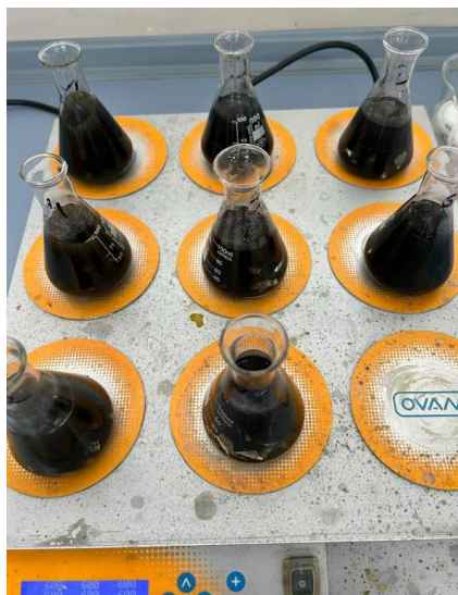
Figura 27: Matrassos sobre l'agitador magnètic
