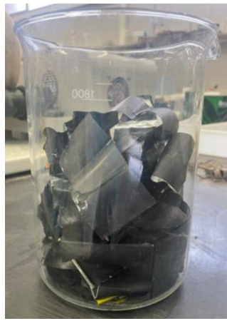
Figura 16: Càtodes abans de ser triturats
