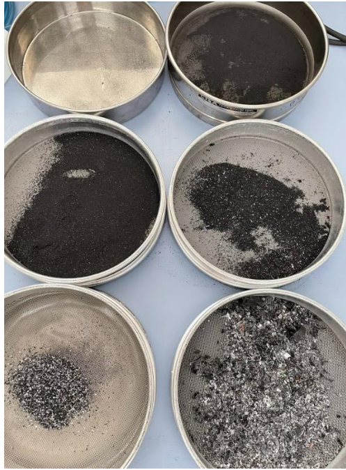
Figura 18: Càtodes tamisats segons la seva granulometria
