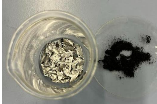
Figura 26: Alumini retallat i mostra de material catòdic
