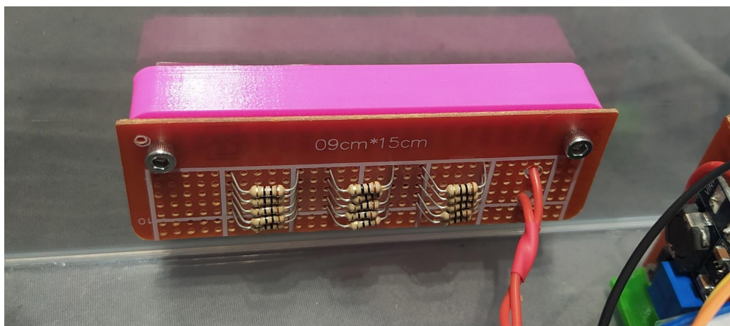
Fig 3.6.2.1.- Resistencia de carga instalada en la caja de electrónica [fuente: elaboración propia]
