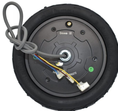
Fig 3.2.1- Motor 300W compatible con Xiaomi M365 [fuente: obtenido de: Iscooting]
