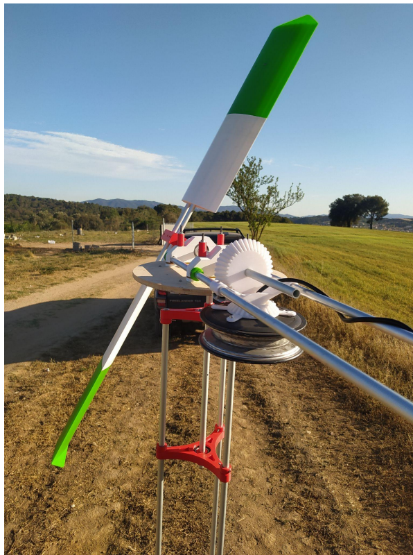
Fig 5.1.1.- Imágen de la turbina eólica completa instalada en el exterior [fuente: elaboración propia]
