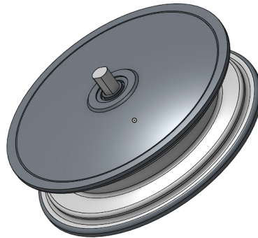
Fig 2.7.1.- Vista isométrica del modelo 3D del motor de imanes permanentes a utilizar en Onshape [fuente: elaboración propia]
