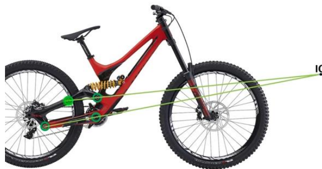
Figura 10: Centre instantani rotació Specialized Demo 8
