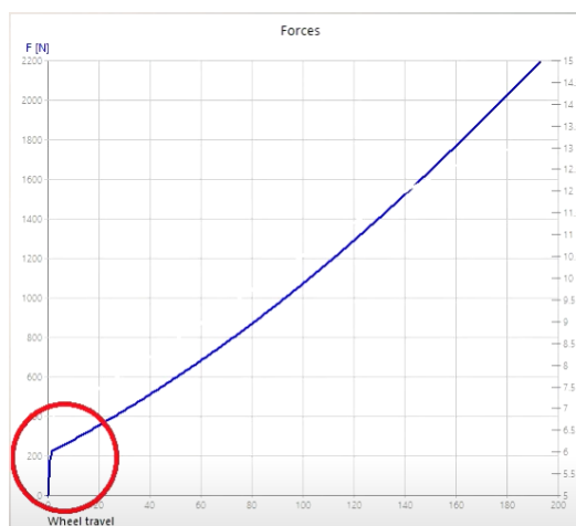
Figura 5: Diagrama força desplaçament roda
