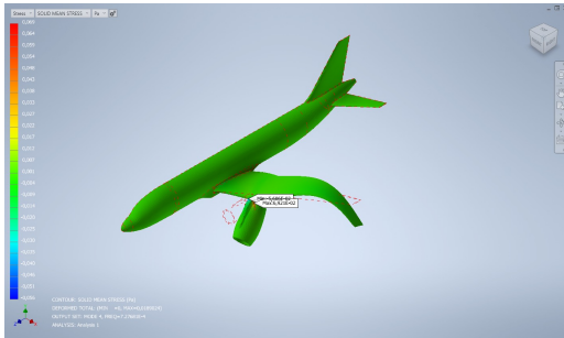
(d) Fourth normal mode. f = 7.2768 \cdot 10^{-4} Hz
