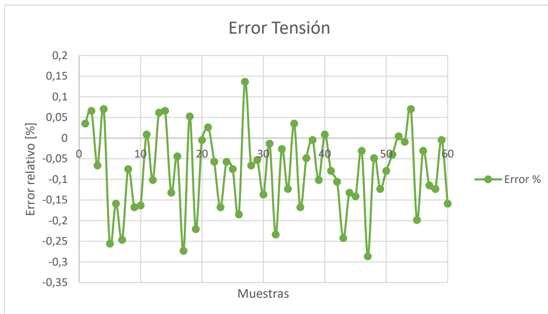
Figura 58. Comportamiento errático de la tensión en la prueba del secador.
