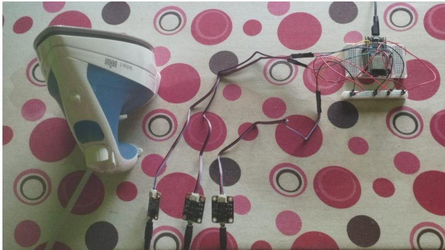
Figura 51. Montaje de la prueba de calibración de los sensores de corriente.
