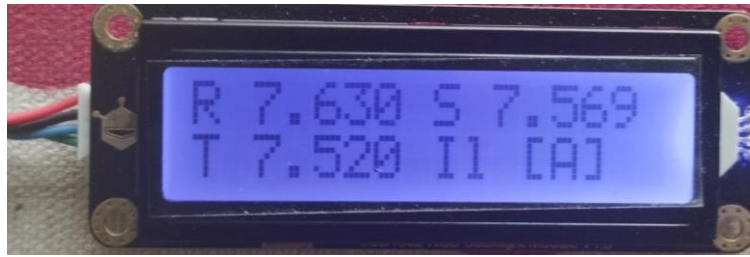
Figura 53. Valores de las intensidades de los sensores de corriente.
