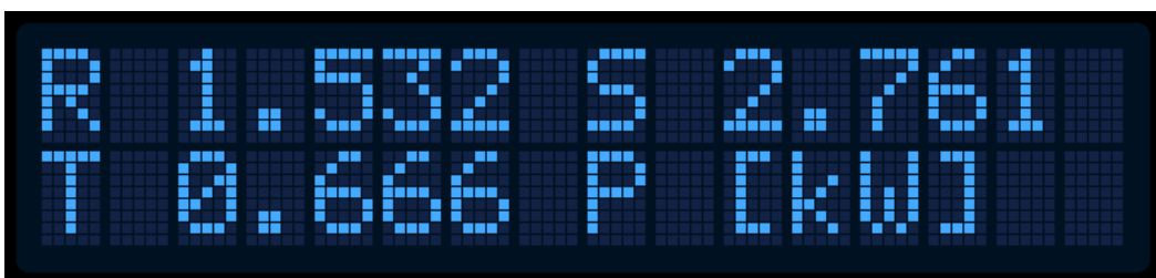
Figura 39. Display de la potencia activa.
