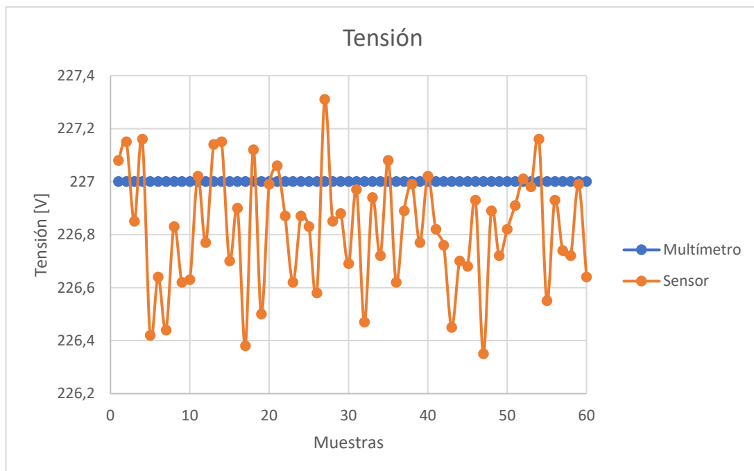
Figura 57. Muestras de tensión del sensor en la prueba del secador.
