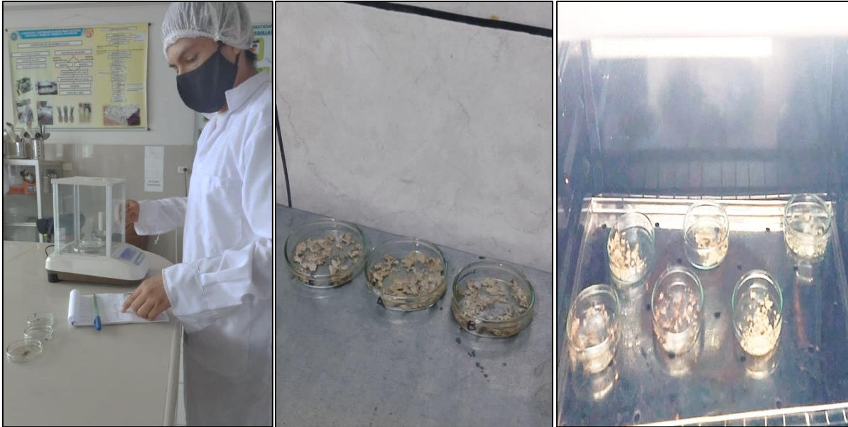
Figura 39. Procedimiento de analisis de humedad
