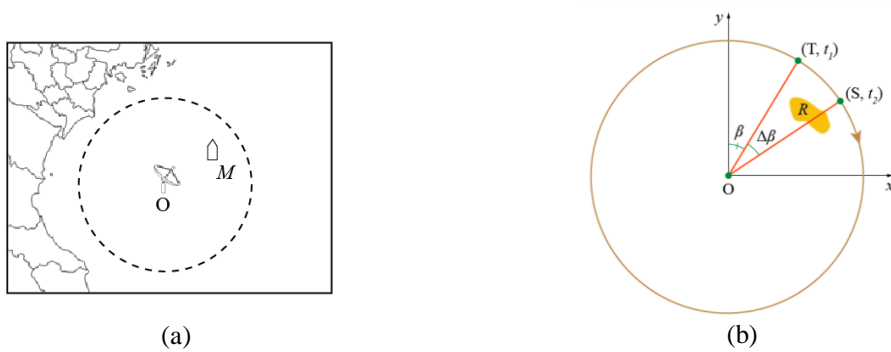
Hình 2. Ra-đa với đối tượng trong thực tế và quá trình hiển thị thông tin ra-đa
