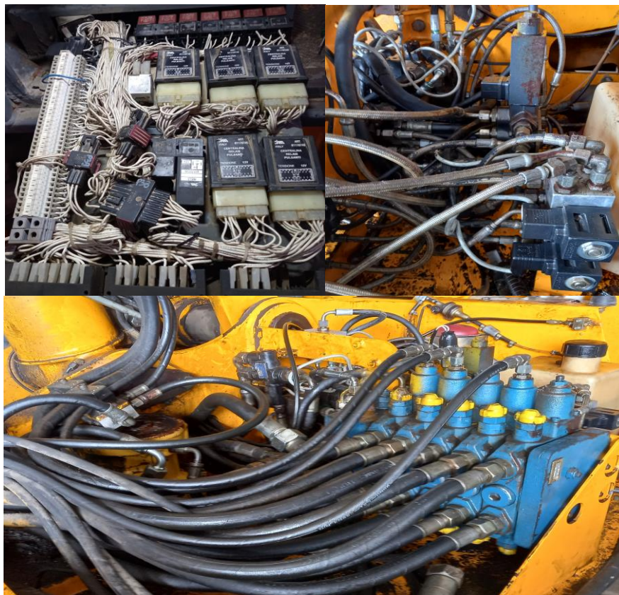
Figura 2.8 – Circuito de relés, circuito de electroválvulas, circuito de mesa de força.
