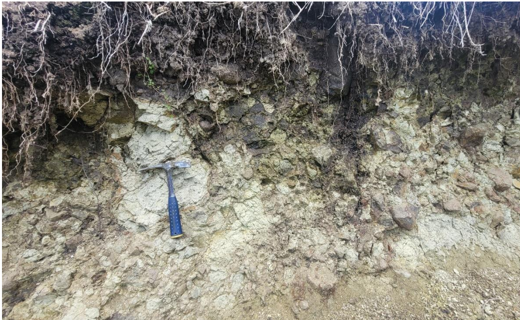
Fotografía 1. Macizo rocoso muy fracturado y altamente meteorizado de la Secuencia volcánica Tual-Puruay Evento 2. Ubicación: E: 767450; N: 9216781; Z: 3222.
