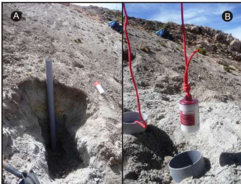
Figura 27. A) Instalación de la estación de medición continua de la temperatura HPT-F1 en el volcán Huaynaputina. B) Foto del momento en que se introduce el registrador HOBO UTL-1 en la estación HPT-F1.
