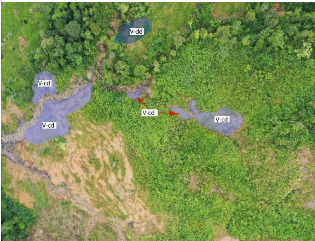
Figura 8. Subunidades geomorfológicas conformadas por piedemonte coluvio-deluvial (V-cd) y Vertiente con depósito de deslizamiento (V-dd).
