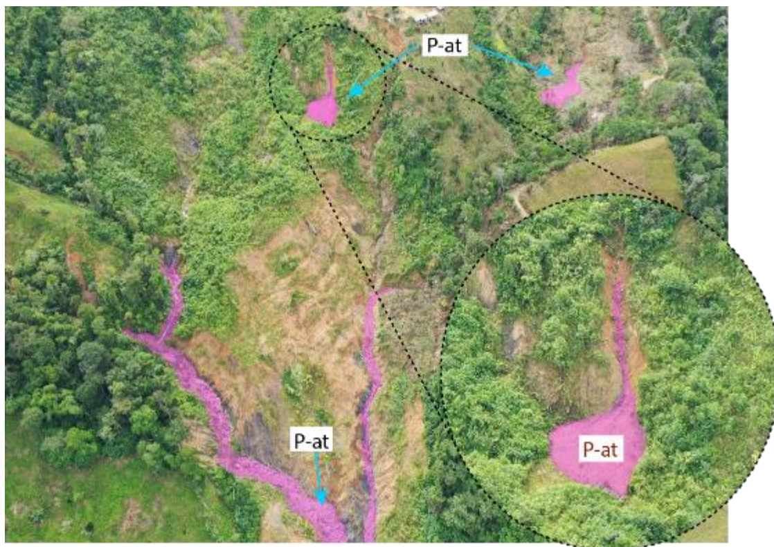
Figura 10. Subunidades geomorfológicas conformadas por Vertiente aluvio-torrencial (P-at), ubicado en el cuerpo del deslizamiento activo.
