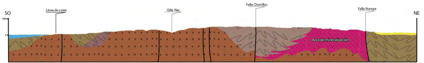
Figura 3. Corte transversal del macizo de Illescas, mostrando las diferentes unidades metamórficas y el área de mineralización, afectadas por diferentes fallas de alto ángulo.
