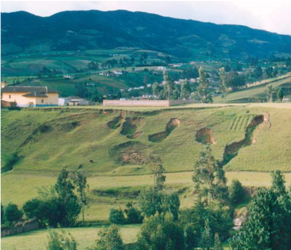
Figura 5.24 Hundimientos múltiples causados por minería subterránea en Pasto, Colombia (Fotografía J. Ojeda).
