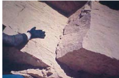
Figura 1.11 Detalle de la configuración de dos diaclasas que condicionan un deslizamiento en cuña (Fotografía D. Salcedo).
