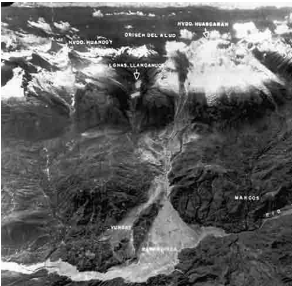
Figura B.4.1 Vista aérea oblicua del evento de 1970 en Huascarán, mostrando la fuente, el recorrido, la devastación del abanico de Yungay y Ranrahirca, y el comienzo del flujo/inundación de detritos distal siguiendo al río Santa hacia la izquierda (Fotografía y anotaciones: Servicio Aerofotográfico Nacional de Perú).
