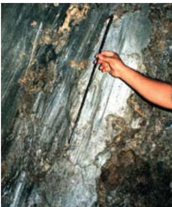
Figura A.4.4 Superficie pulida y estriada dentro de la brecha de falla encontrada en la galería exploratoria.
