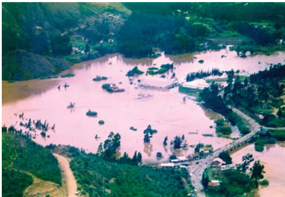
Figura A.17.6 Efectos de la inundación 2 km aguas arriba del deslizamiento (01-04-93). En el centro, la Central Termoeléctrica y en la esquina inferior derecha un puente y la Carretera Panamericana. (Tomado de Zevallos et al, 1996).
