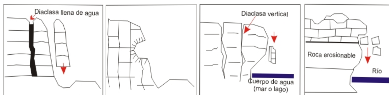
Figura 7.1 Ejemplos de causas que producen caídas (Colas y Pillot, Varnes, 1958).
