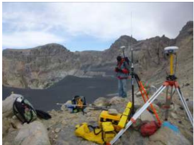
Personal del OVI realiza monitoreo geodésico con equipos GPS en el cráter del volcán Ubinas.
