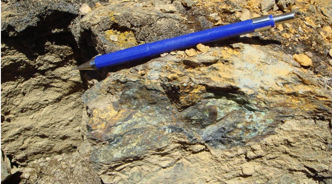
Foto 12. Mineralización de cromita-pirrotita-óxidos de níquel?, con geometría podiforme.
