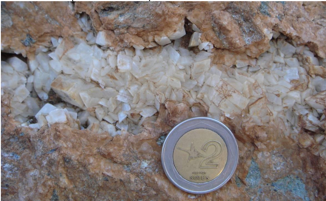
Foto 15. Presencia de carbonatos cristalizados relleno de fracturas.
