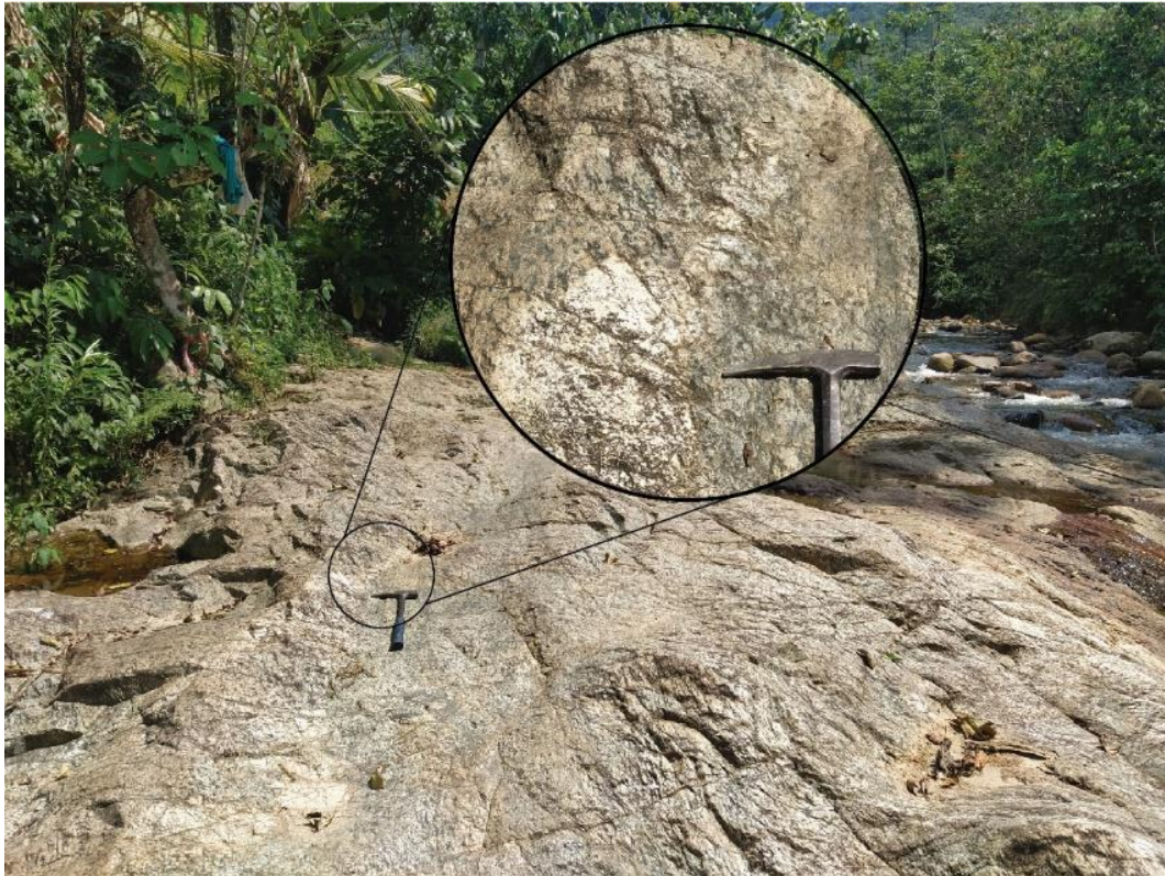
Figura 5: Se observan el afloramiento de roca intrusiva (Monzogranito), en la margen derecha del río Panamá, coordenadas UTM-WGS-84, 18s; X:531130, Y: 8746414.
