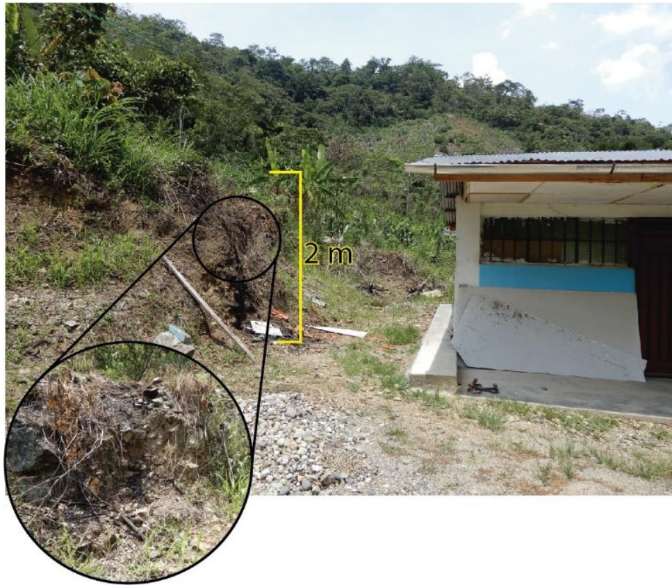
Figura 4: Depósito coluvio deluvial, conformado bloques heterométricos > 50cm, en una matriz areno-limosa, coordenadas UTM-WGS-84, 18s; X:530925, Y: 8746408.
