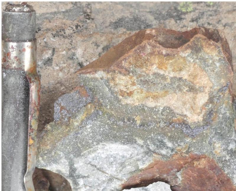
Figura 2.7. Arenisca gris cortada por vetillas de molibdenita y calcopirita; trazas de bornita y pirita diseminada (713,070E - 8°403,950N)
