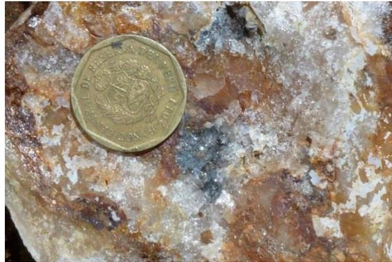
Figura 5.1.14. Detalle Muestra GE2812-006 (715,920E-8'403,718N) con 0.3% Cu y 113ppm Mo,
