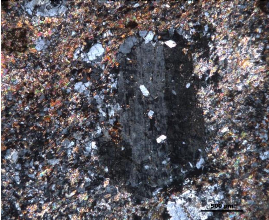
Figura 6.1.10: Fenocristal de plagioclasa alterada por cuarzo hidrotermal y sericita superpuesta a biotita secundaria en pórfido cuarzo-monzodiorítico (muestra GE2812-319) que se observa en sección delgada.
