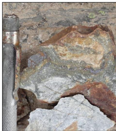
Figura 5.1.9. Detalle de la muestra GE2812-002. Cuarcita con alteración tipo skarn de piroxenos, cortada por vetillas de molibdenita y calcopirita; bornita y pirita diseminada, pátinas de crisocola y concentraciones de pirrotita.
