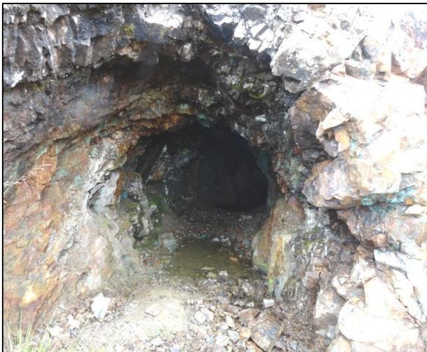
Figura 5.1.13. Socavón abandonado de la Mina San Diego (716,928E- 8'400,464N), a lo largo de una estructura silícea con pátinas de crisocola, malaquita y vetillas de molibdenita, junto a concentraciones de calcopirita.
