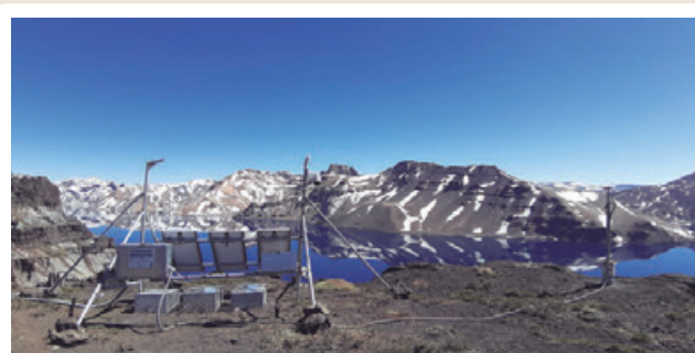
► Fig. 6 - Estación Epulafquen (EPU) perteneciente a la red binacional de monitoreo volcánico del volcán Lanín.
