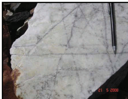
Figura 6. Stockwork de venillas de molibdenita del prospecto Jacobabamba.
