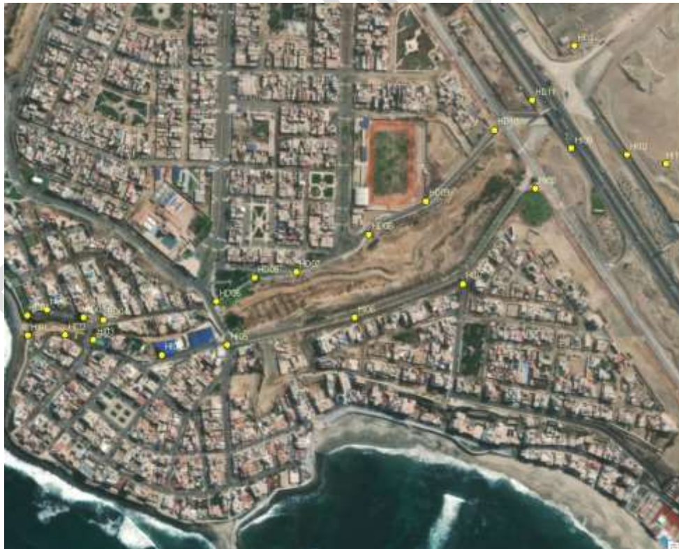
Figura 5.1 Zona crítica 285: Puntos identificados por el ANA en el año 2019, se observa que el Complejo Deportivo y algunas viviendas se encuentran dentro de la Faja Marginal de la quebrada Malanche.
