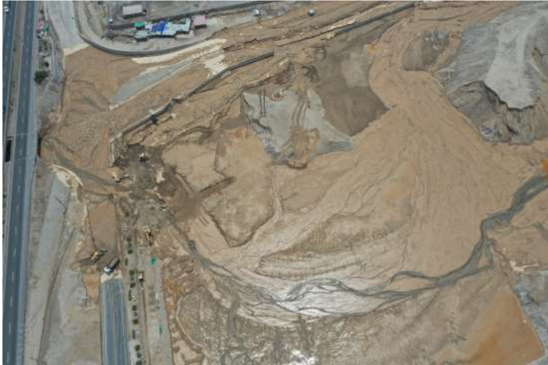
Fotografía 5.5 Zona crítica 285: Aguas arriba de la quebrada Malanche, se observa que gran parte del depósito del flujo se discurrió por la cantera antes de llegar a la Carretera Panamericana Sur, el pontón de la carretera es insuficiente para el ancho del cauce de la quebrada.
