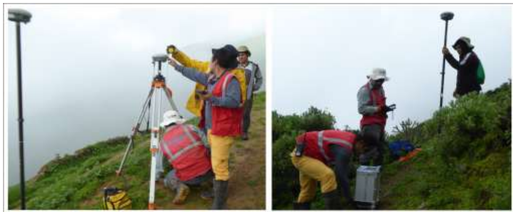
Fig. 6.5 Recolección de datos de gravedad y GPSD en el ANAP Zona 2 Bloque 1.
