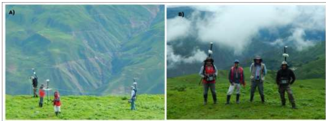
Fig. 6.3. Ubicación de un magnetómetro como estación Base en la imagen (A) alejada de cualquier interferencia o ruido cultural y en (B) brigada de Magnetometría Terrestre.
