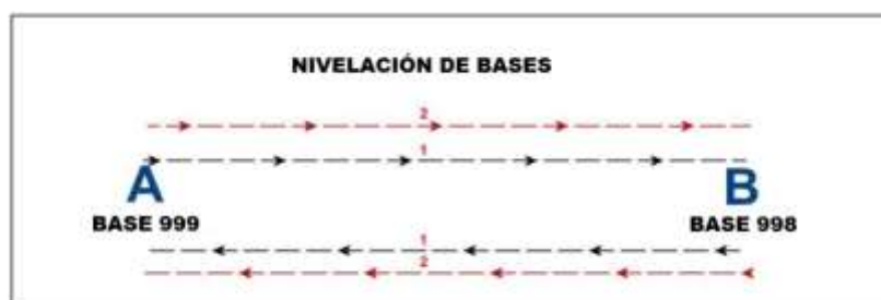
Fig. 6.6. Nivelación de bases – ANAP Zona 2 Bloque 1
