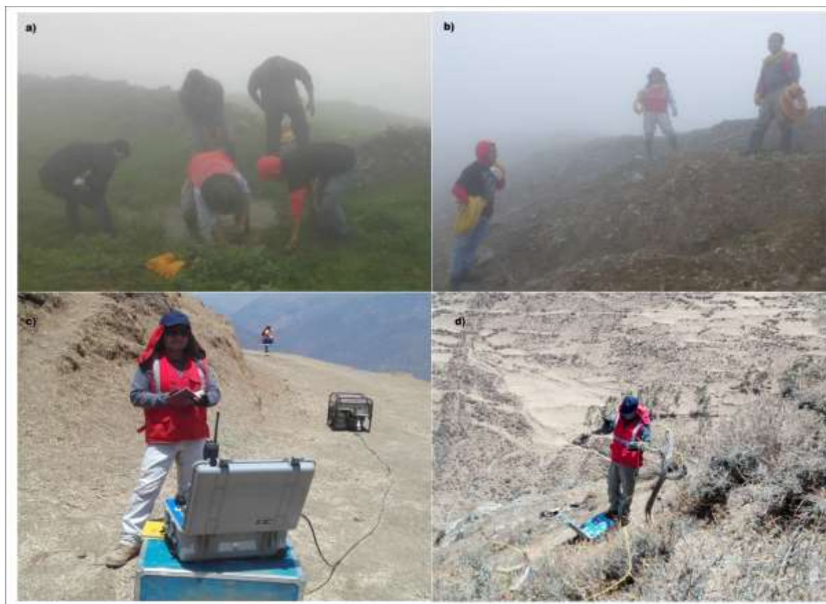
Fig. 6.8. Preparación, traslado y registro de información de polarización inducida 2D.
