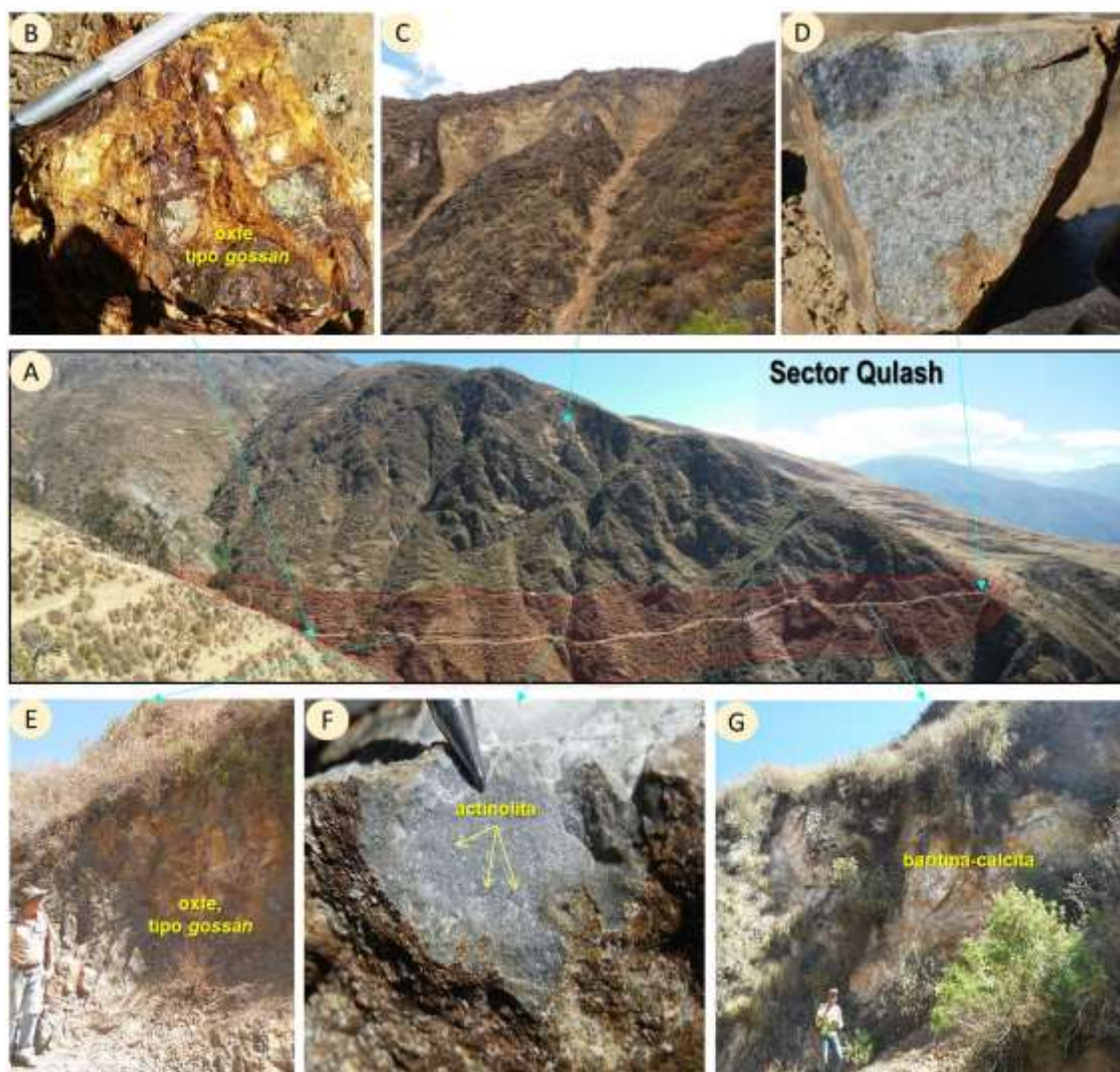
Foto 3.8. A) Sector Qulash. Mineralización diseminada de pirita-pirrotita±calcopirita en andesitas del Grupo Casma fuertemente silicificadas con presencia de baritina y calcita. La andesita tiene estratificación de orientación Az 340°/40-50°NO, y la alteración y mineralización persiste en un tramo de ~800 m, quedado abierta hacia la parte superior e inferior que se encuentra cubierta por material cuaternario y vegetación. B-E) Presencia de óxidos de hierro tipo gossan (restringidas). C) Hacia la parte superior se muestra la andesita fuertemente alterada a sílice-argílica. D-F) Se nota una alteración de fuerte silicificación con diseminado de pirita-pirrotita. G) Zonas de baritina-calcita.
