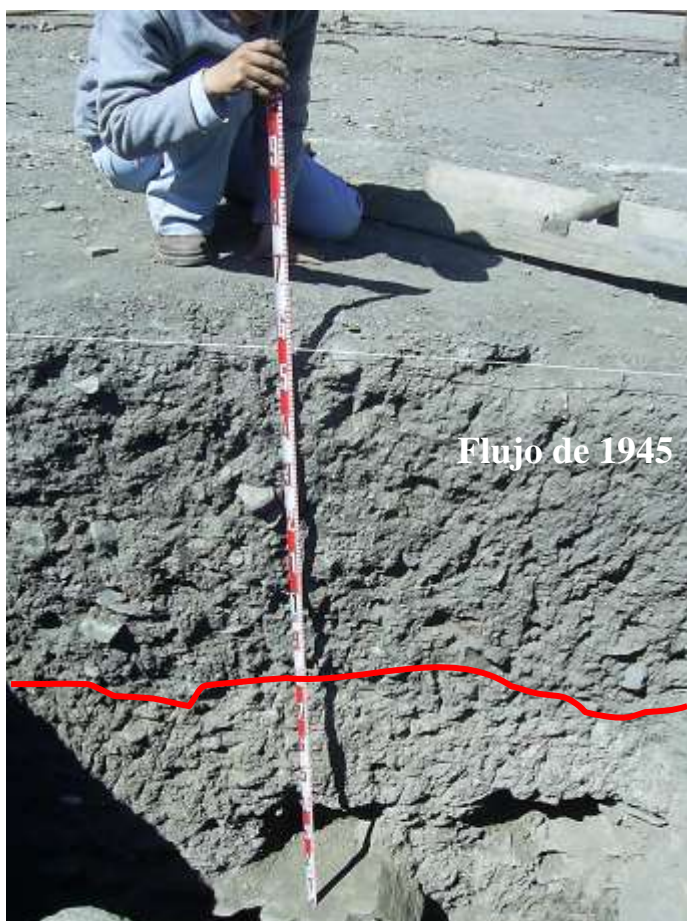
Foto N° 13: Calicata ubicada en las cercánias de la Plaza de Armas de Chavín, sector Mercado Municipal, en el se observa el espesor del flujo de detritos de enero de 1945, que llegó a alcanzar hasta 1 m.
