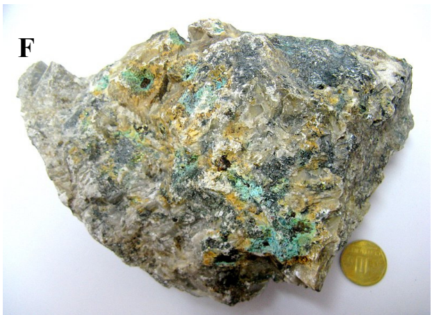
Foto 03.- A) y B) Venillas de calcita con calcopirita. C),D), E) y F) Calcopirita disseminada formando halos de malaquita y azurita. Prospecto Huallpachaca.
