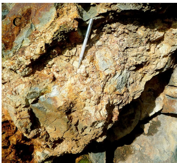
Foto 06.- A), B), C) y D) Brechas mineralizadas (py + cpy). Prospecto Huallpachaca.
