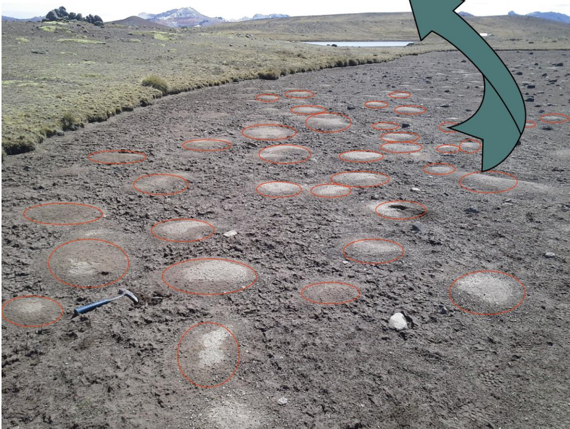
Figura 10. Detalle de volcanes de arena formados adyacentes a lagunas, en la parte superior una explicación de su origen tomado de Rodríguez Pascua et al., 2015.
