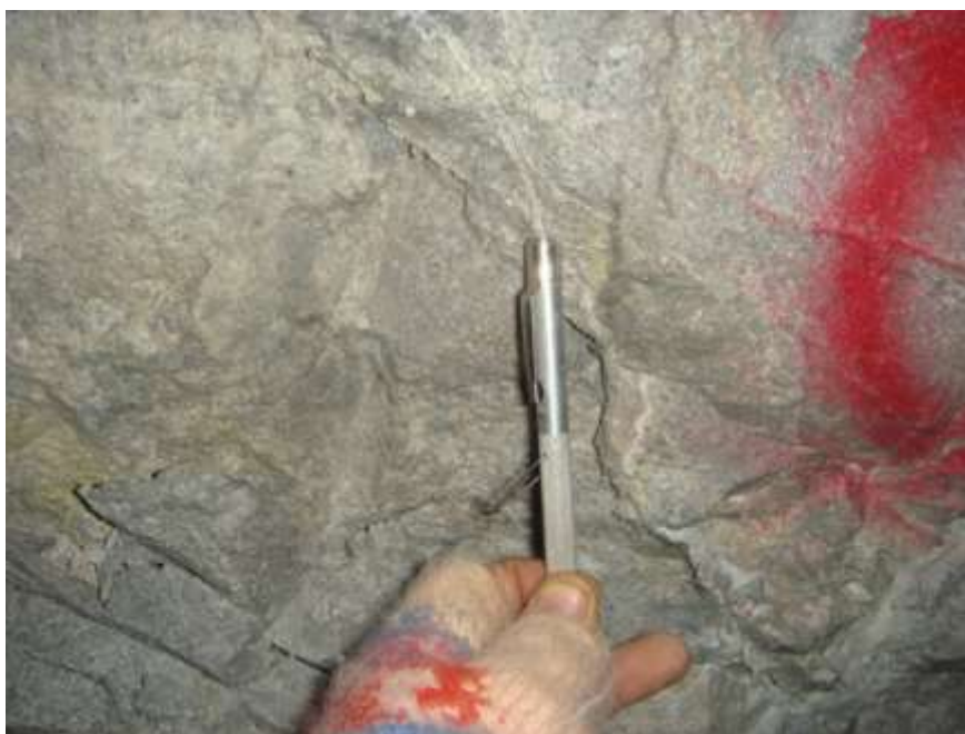
Fotografía 4.29.- Sistema de venillas del sistema V2 en las de las tobas del Gpo. Barroso en Palla Palla.
