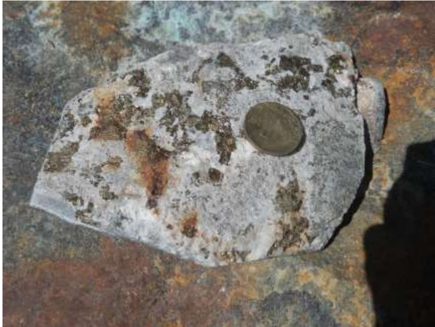
Fotografía 4.59.- Pirita en agregados y óxido de Fe con relleno de fracturas y en pátinas. La pirita es fina y cristalizada, en algunos sectores oxidada (Muestra 28m-RMT-006).
