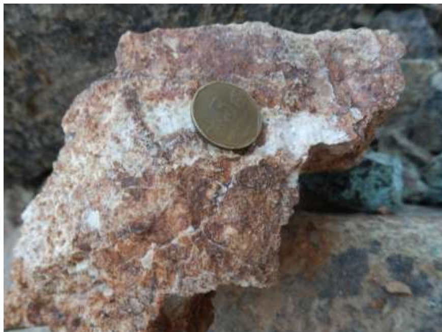
Fotografía 4.51.- Estructura vetiforme de óxido de Fe con arcillas y con venillas de cuarzo-magnetita (Muestra 29n-RMT-003).
