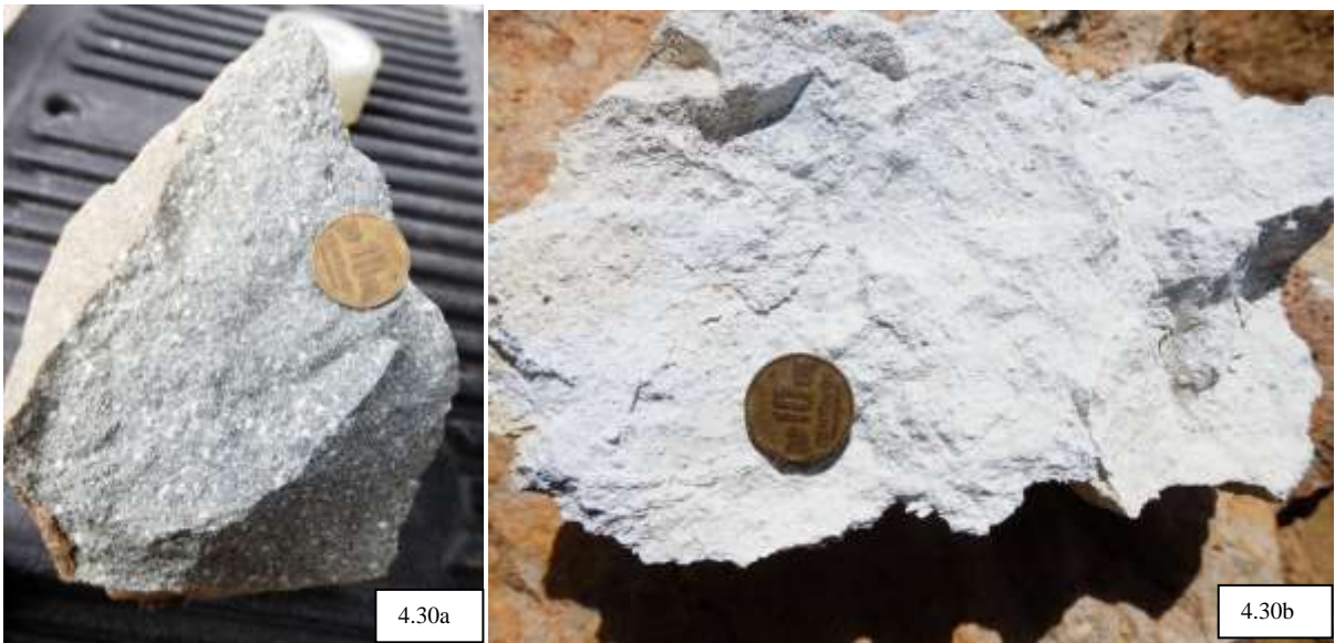
Fotografía 4.30.- (a) Pórfido andesítico con fenos de plagioclasas (Muestra 27m-RMT-022). (b) Pórfido argilizado y silicificado con diseminación de óxidos (Muestra 27m-RMT-018).
