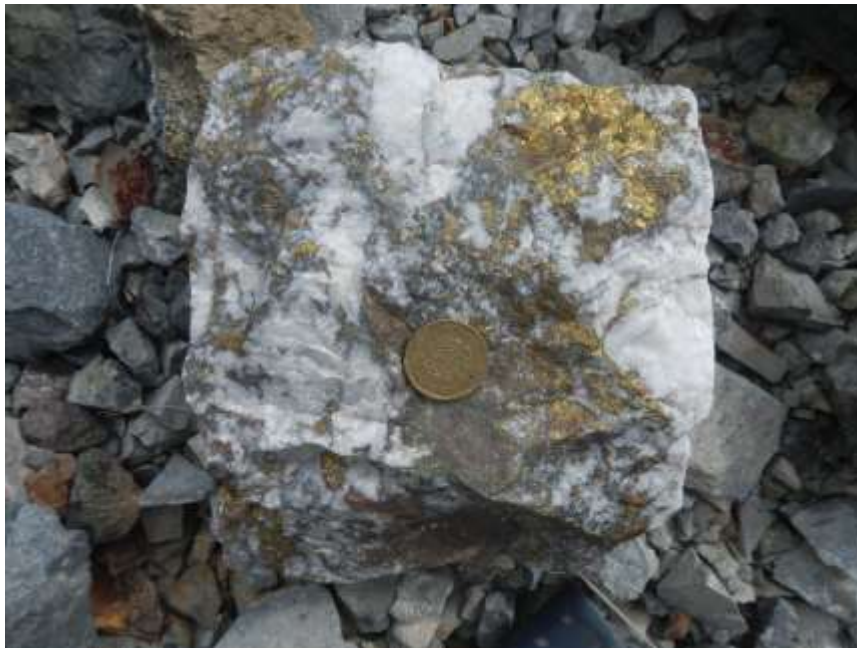
Fotografía 4.73.- Vetas de cuarzo con calcopirita, galena, esfalerita y pirita cortando toba cristalolítica (Muestra 28m-RMT-018)
