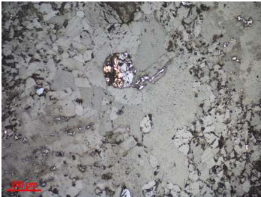
Fotomicrografía 4.33.- Zona de skarn con abundante vetilleo de calcita con roca hospedante alterada con clorita y abundante epidota con algunos niveles marmolizados de la muestra 29m-MMT-012 en sección pulida con aumento de x10. Pirita:py
