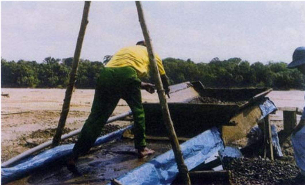
Foto N°7.2 Método de explotación artesanal del oro aluvial, selección del material, río Madre de Dios, cuadrángulo de Valencia.
