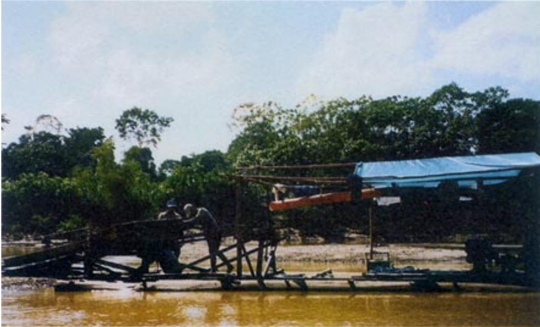
Foto N° 7.1 Método de explotación artesanal del oro aluvial, lavado de la muestra, río Madre de Dios, cuadrángulo de Valencia.
