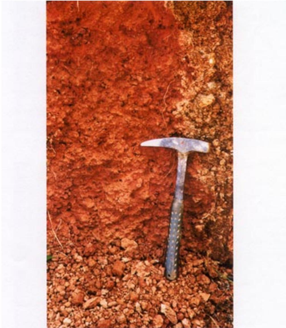
**Foto N° 7.5** Capa de suelo laterítico compuesto por hierro oolítico, en la Formación Madre de Dios. Este material es utilizado para el afirmado de carreteras. Campamento San Juan km. 125 de la carretera Iñapari-Mavila. Coordenadas UTM: 8718923N, 409747.
