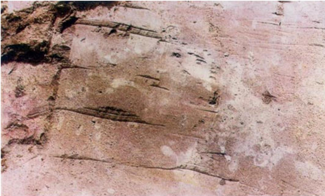
**Foto N° 7.3** Bancos de arenas semiconsolidadas de la Formación Madre de Dios con condiciones para ser utilizadas como material de construcción.
