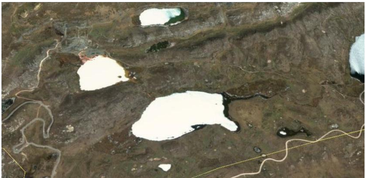
Figura 6. Vista satelital que muestra drenaje ácido generado en minas de carbón que drenan o vierten sus aguas a las lagunas Ayhuin. La vista inferior muestra el detalle de los impactos en la laguna superior y ésta a su vez que desagua hacia la laguna inferior.
