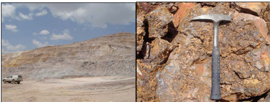
Fotos 8 y 9. Vista panorámica del tajo abierto del depósito Quicay y detalle de brechas síliceas con matriz de óxidos con contenidos mayores de oro hasta 40 g/t Au.
