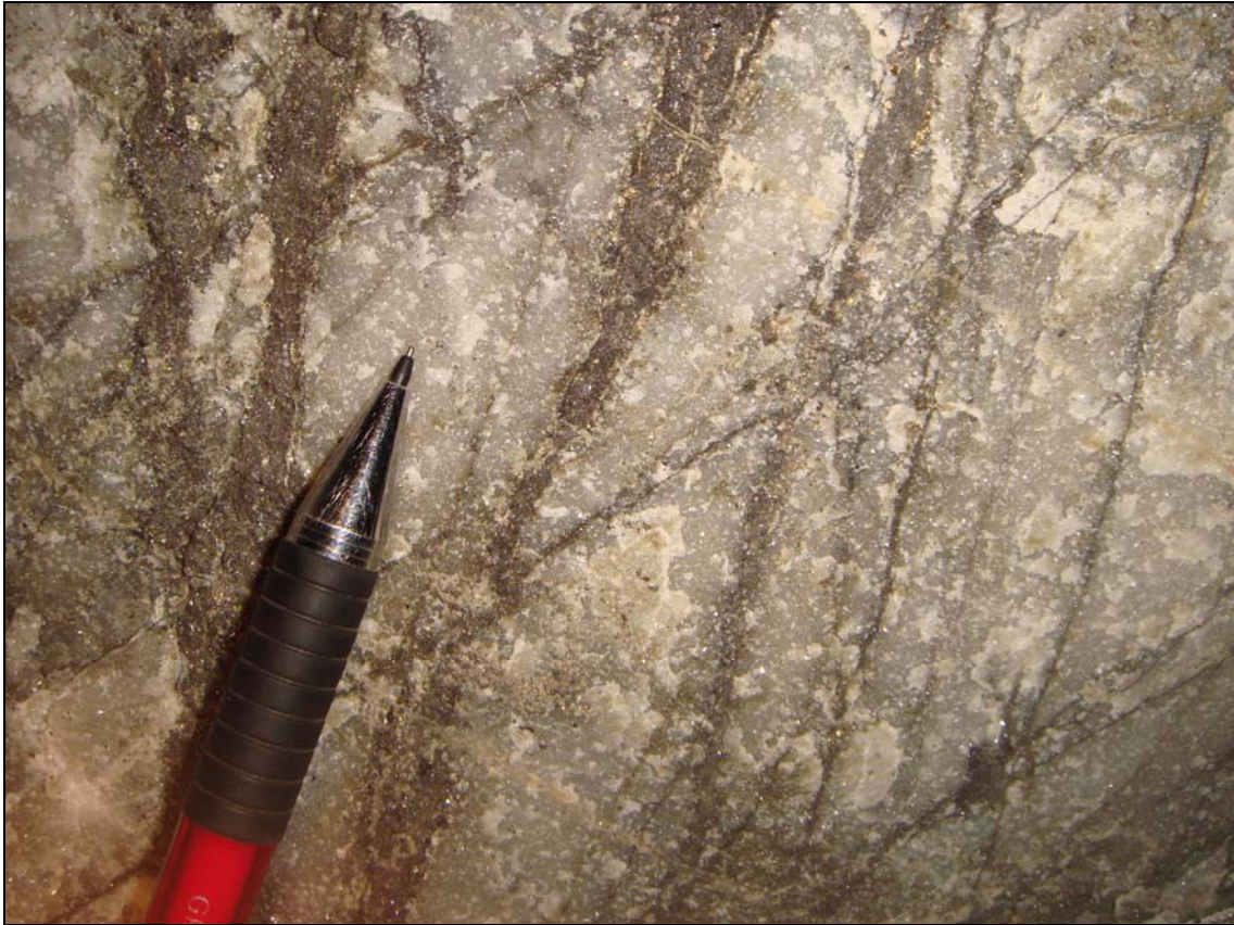
Foto 7. Calcita masiva cortada por dos generaciones de vetillas de esfalerita con trazas de calcopirita. Depósito Milpo.
