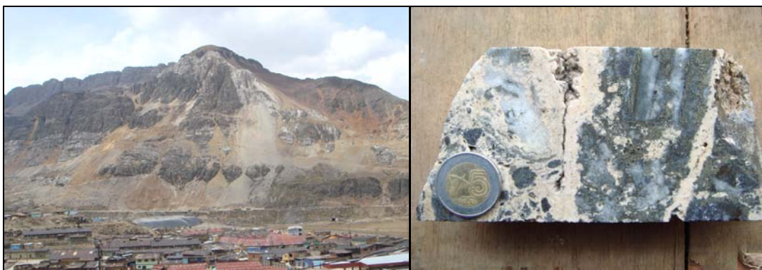
Fotos 15 y 16. Vista panorámica del distrito minero de Morococha y detalle de una estructura mineralizada constituida por pirrotita, galena, esfalerita, pirita y rodocrosita.
