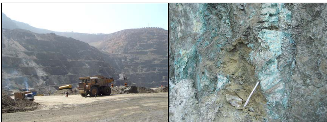
Fotos 10 y 11. Vista panorámica del tajo abierto del depósito Cerro de Pasco y detalle de una estructura con minerales de cobre cortando a un cuerpo masivo de pirita-pirrotita.
