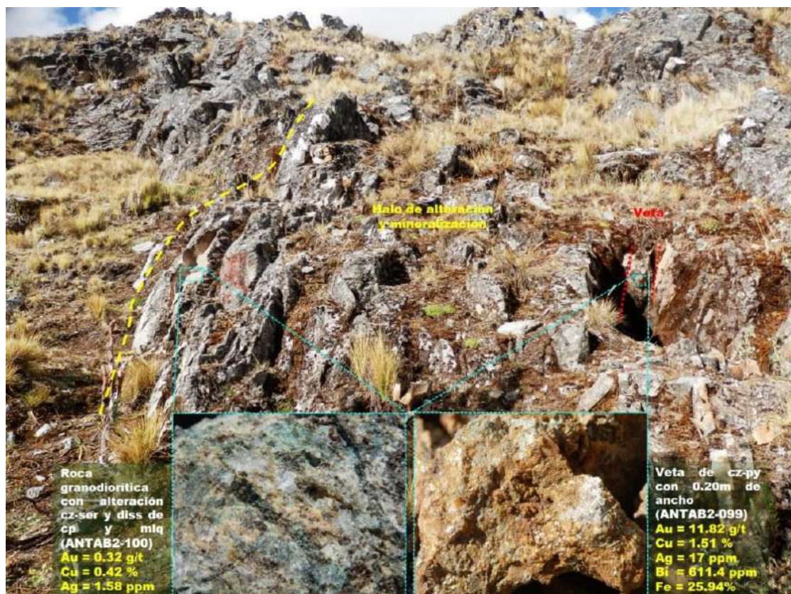
Foto 3.17. Veta de cuarzo, pirita semi-masiva en el orden 5% y óxidos de hierro, asimismo, la roca de caja con alteración cuarzo-sericita y calcopirita diseminada con malaquita en un halo de 3 m. La veta tiene un rumbo N75°E y buza 70°NO con 0.2 m de potencia y ~2 m de longitud, discontinuo, se ubica en las coordenadas 726832E; 8446602N. Vista mirando al noreste.
