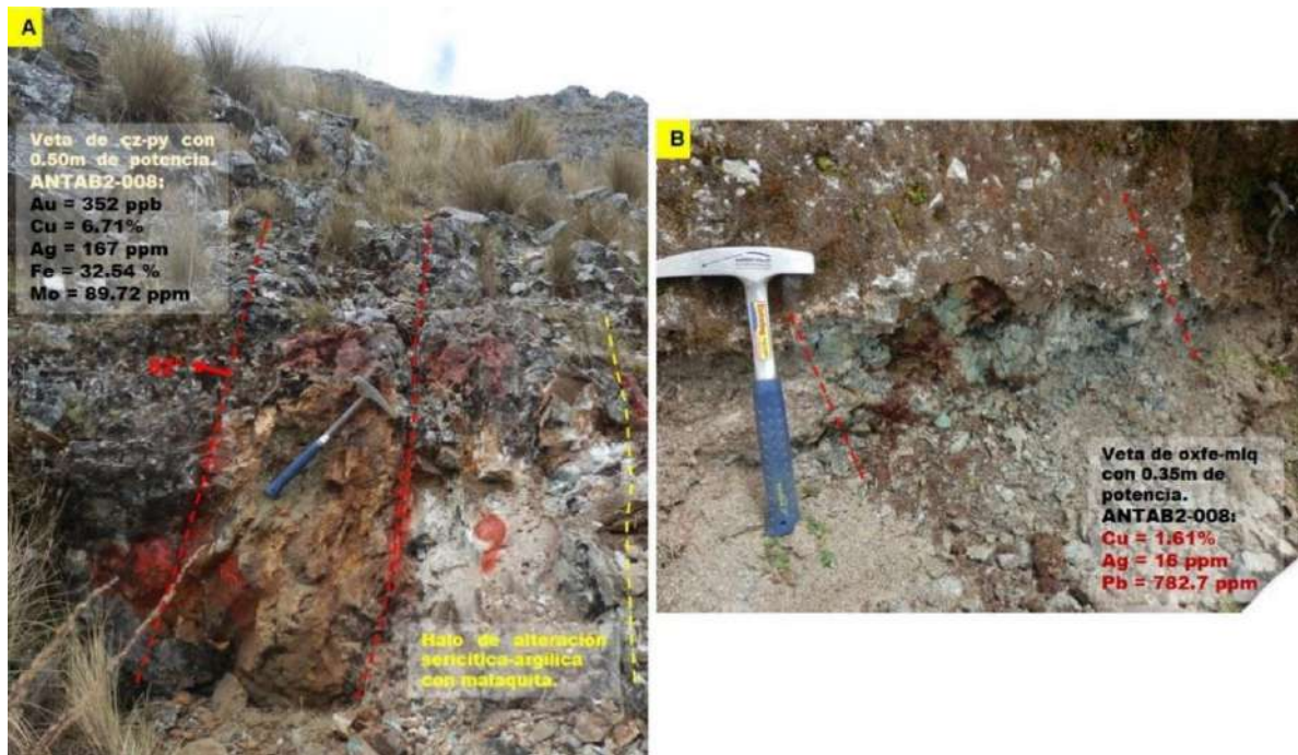
Foto 3.16. A) Veta de cuarzo, pirita y OxFe (ANTAB2-008) tiene un rumbo N55°O y buza 82°NE, con 0.50m y ~3m de longitud. B) Veta de OxFe y malaquita (ANTAB2-002) con rumbo N45°O y buza 60°NE de 0.35m de grosor y 2 m de longitud, se pierde con la cobertura del suelo. Ambas vistas mirando al sureste.
