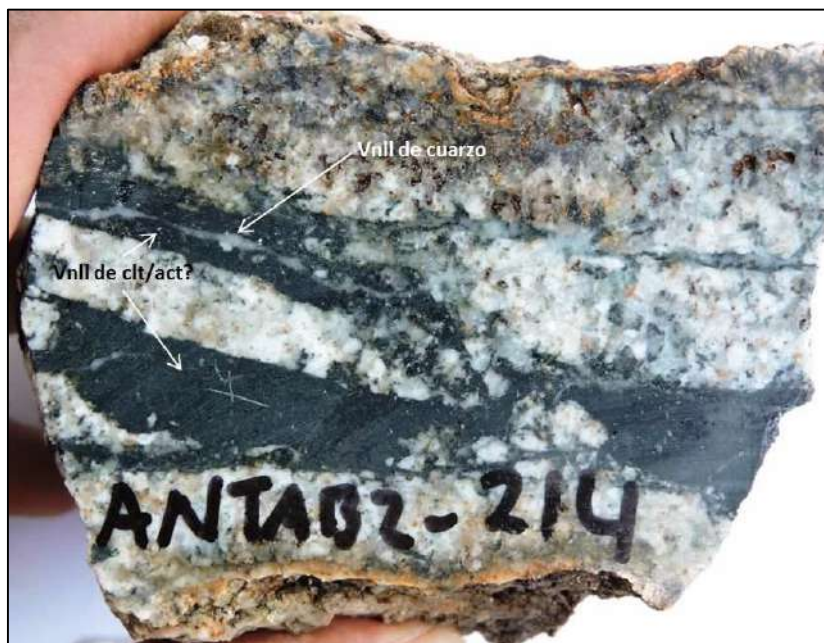
Foto 3.13. Muestra ANTAB2-214, vetillas de clorita/actinolita cortada por venillas de cuarzo y halos de sílice-sericita-albита?. La estructura tiene 15 cm de ancho, con rumbo S45°E y buza 83° al suroeste.
