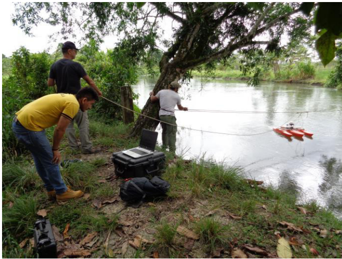
Figura 7 - Aforo del Río Negro con ADCP
