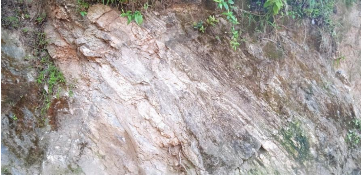
Figura 32. Filitas y tobas pizarrosas con cuarcitas muy fracturadas, coordenadas 9447468N y 647902E
