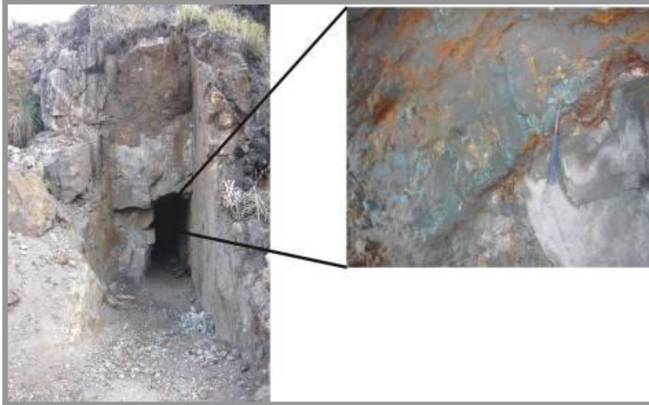
Foto N° 26: En la foto de la izquierda se muestra el túnel de la Mina Santo Toribio, y foto derecha se aprecia la mineralización (óxidos y sulfatos de Cu).
