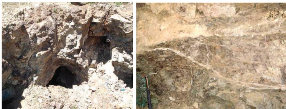
Figura 3.6.- Vista de las labores abandonadas en la mina Media Flor y detalle de la veta con óxidos de cobre controlado por la estratificación.
