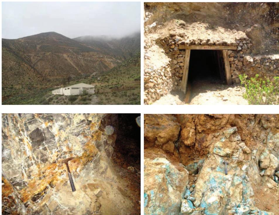
Figura 3.3.- Arriba, vistas de las instalaciones y labores de la mina abandonada Ataspaca. Abajo, detalles de la mineralización en vetas con óxidos de hierro y sulfuros (esfalerita, arsenopirita, pirita), y óxidos cobre (malaquita, crisocola).
