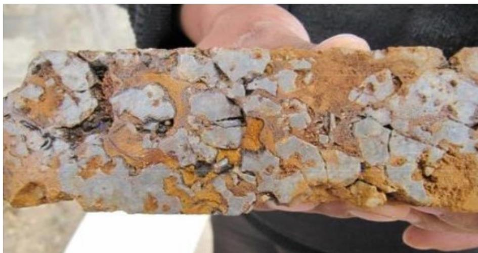
Figura 4.9 Textura gusano en pórfido de cuarzo. Muestra de testigo de perforación. (Departamento de Exploraciones Minsur S.A)
