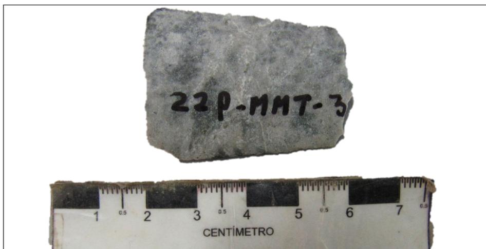
Figura 4.25 Roca hipobasial silicificada, compacta, de color gris a gris blanquecino y con textura porfírica con matriz silicificada. Está conformada por escasos cristales y moldes de feldspatos inmersos en una matriz afanítica alterada. Además, se observan vetillas con relleno de cuarzo secundario.
