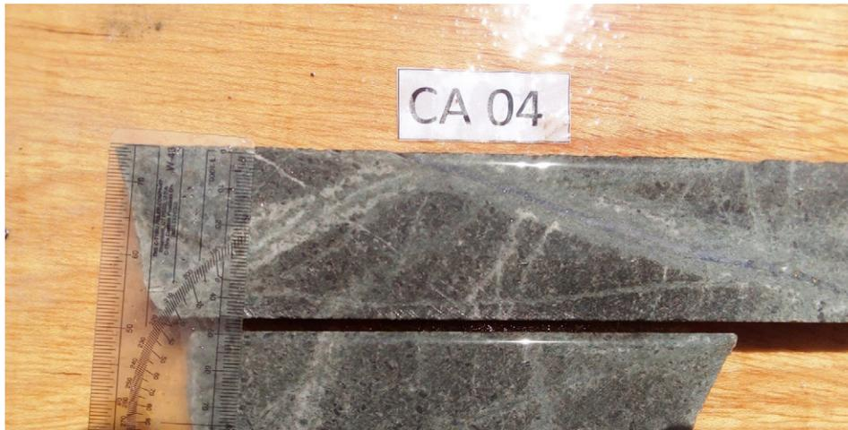
**Fotografía 4.11** Muestra 34t-RMT-352 Diorita de grano fino a medio con alteración potásica, biotita secundaria. Anhidrita en venillas. Estructuras tipo *stockwork*. Calcopirita en venillas
