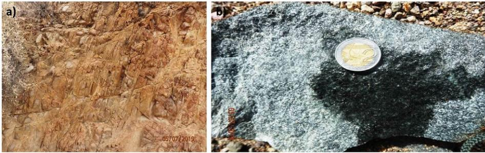
Fotografía 4.17 Muestra 34u-RMT-286Coord. 303051 E 8131613 N h= 3163 m Roca intrusiva color gris claro, textura granular además abundante piritita. Roca fracturada tipo enrejado
