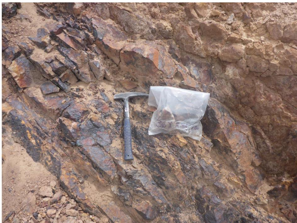
**Fotografía 4.4** Muestra 36x-RMT-205 Coord. 406530m E 8048450m N h= 4790 m roca volcánica asociada a la Formación Huilacollo, con fuerte silicificación; además, presenta oquedades tapizadas con óxidos de hierro (hematita, goetita, jarosita) tipo sílice *vuggy*. Estrato N30°O/30°SO
