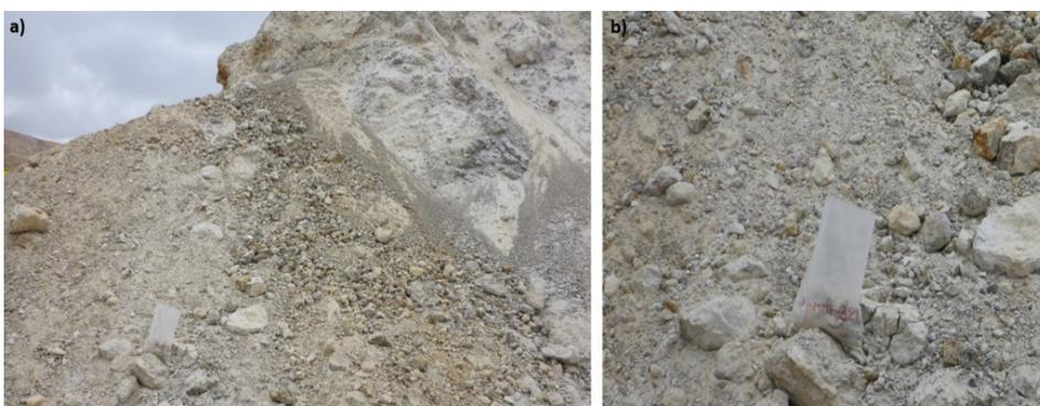
Fotografía 4.6 Muestra 36x-MMT-324 Coordenadas: 414636E / 8029331N. Brecha polimictica con fragmentos de sílice, dacita y andesita, con alteración argílica avanzada (cuarzo-alunita). Muestra tomada de cuerpo principal del tajo (banco 27)
