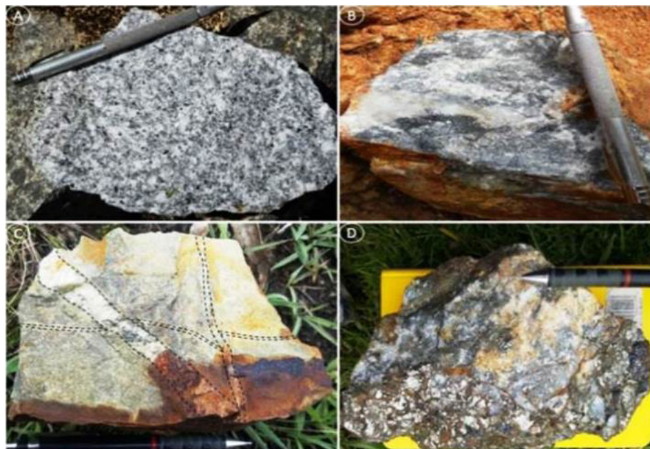
Figura 6.23 a) Intrusivo granodiorítico con textura porfídica; b) Detalle de la Veta Bonanza de cuarzo con estibina, galena argentífera, pirita y trazas de calcopirita; c) Detalle del stockwork de cuarzo-molibdenita en arenisca; d) Detalle de la Veta Abel, cuarzo con mineralización masiva de sulfuros; pirita, arsenopirita, pirrotita, estibina y calcopirita.
