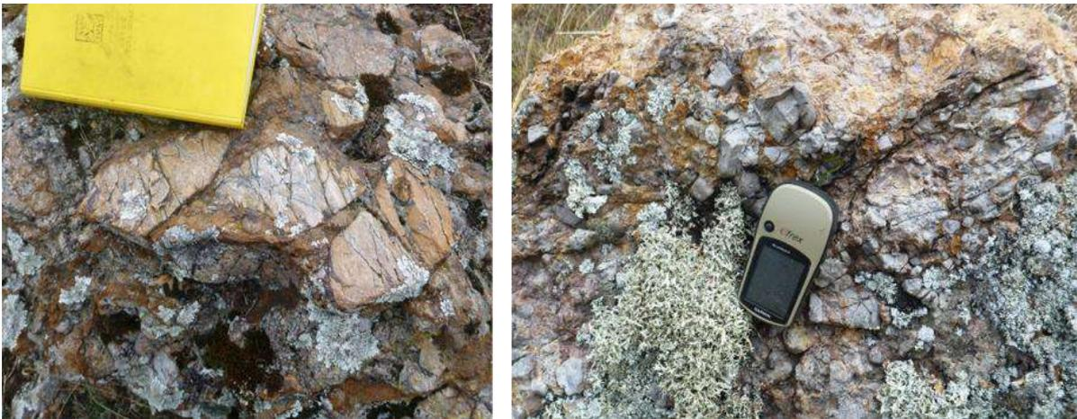
**Foto 5.12** Detalle del cuerpo de brecha freática con matriz soportada tipo polvo de roca cuyo cemento es sílice arcillas también se registra presencia de carbonatos siderita y smithsonita.
