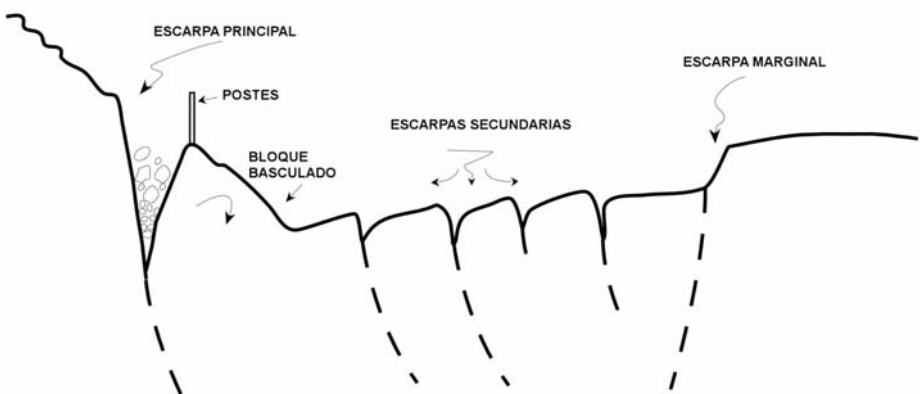
Figura 4: Perfil esquemático interpretativo del sector Tambo de Mora - Sunampe.
