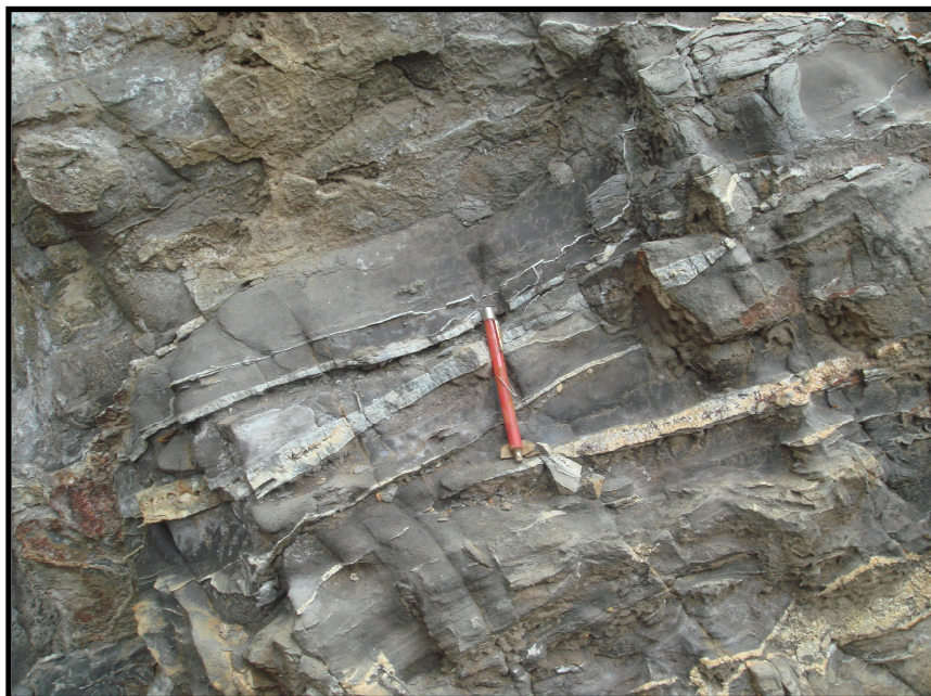
Fotografía N° 1.- Calizas micríticas dolomitizadas de la Fm. Condorsinga, con vetillas y pequeños mantos de cuarzo en la bocamina de Florcita.
