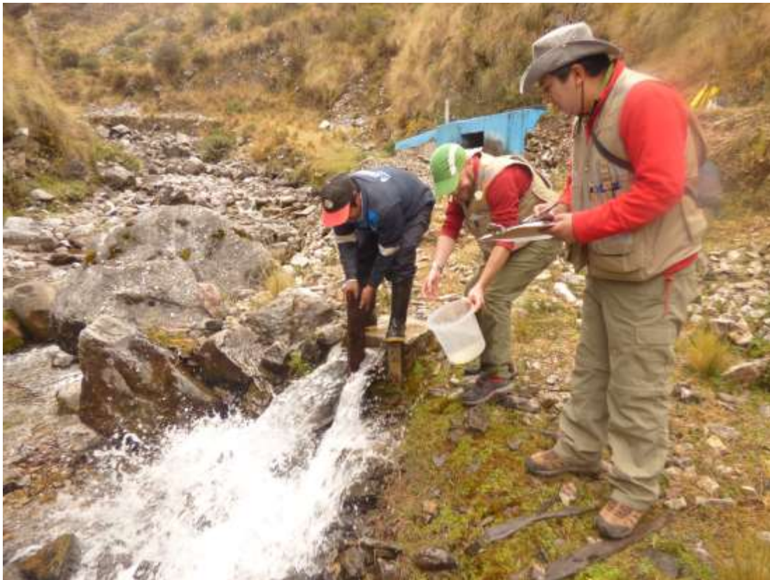
Fotografía 7.7 Manantial Ancall, aforo diferencial en el punto de mayor producción del manantial
