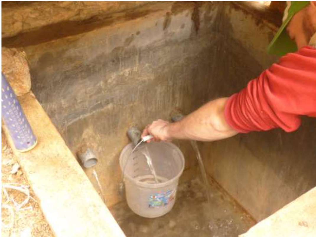
Fotografía 7.1 Manantial Dos de Mayo, aforado con el método volumétrico, Q = 0.5 L/s.
