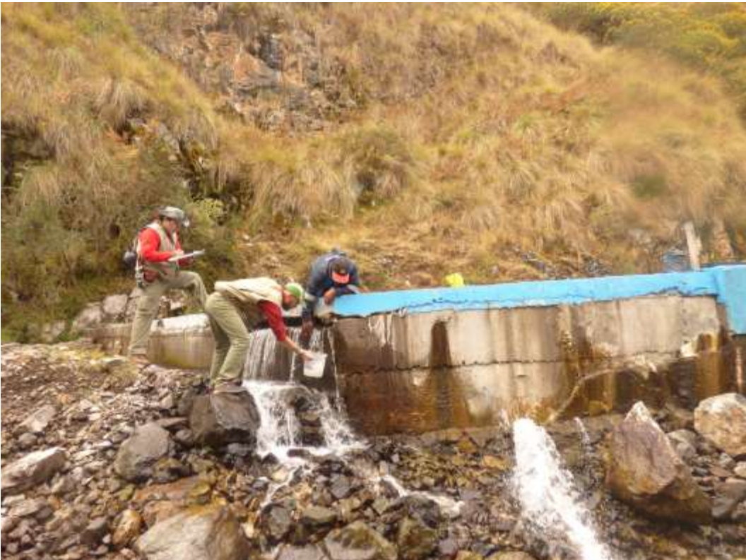
Fotografía 7.3. Aforo del manantial captado Ancall con el método volumétrico, Q = 104.0 L/s.
