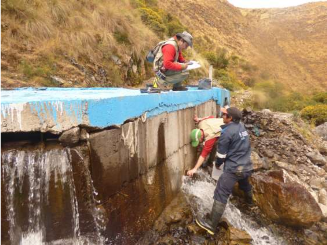
Fotografía 7.6 Manantial Ancall, aforo diferencial en diversos puntos de la surgencia que desborda la capacidad de la infraestructura de captación instalada.
