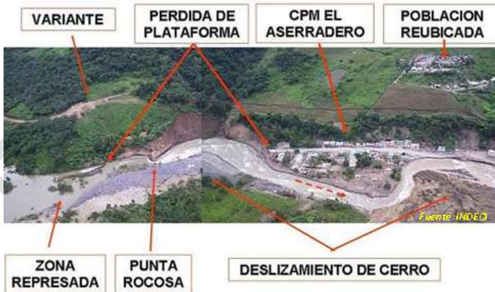
Fotografía 2.12. Centro Poblado Aserradero después del desastre. La zona fue afectada por deslizamientos, inundación y erosión fluvial.
