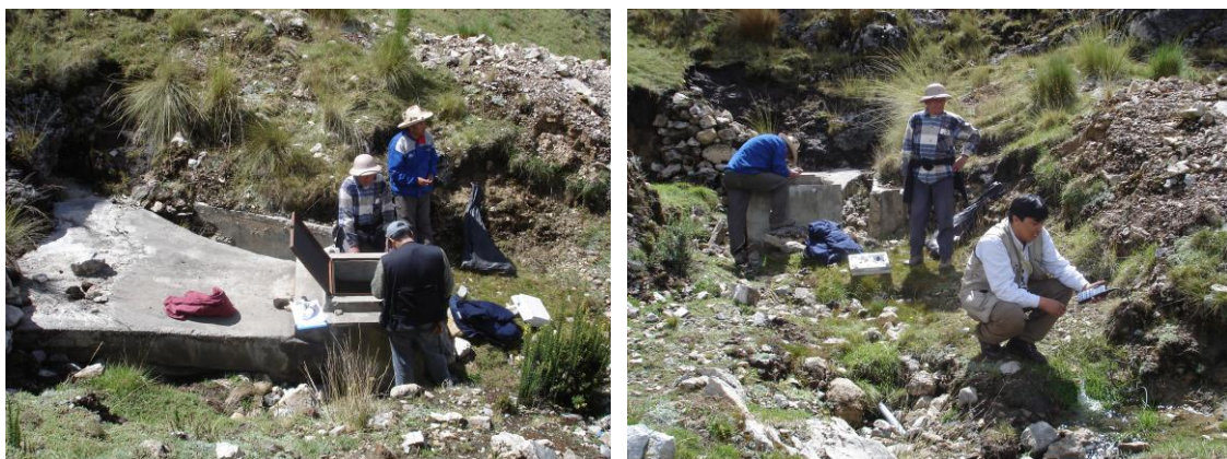
Figura 9. Manantial Huaylla Ucro. Sistema de captación directa del manantial y medida de parámetros fisicoquímicos de la surgencia de agua.
