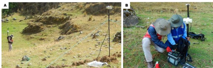
**Fig. 7.1.-** Preparación e instalación del magnetómetro base.
