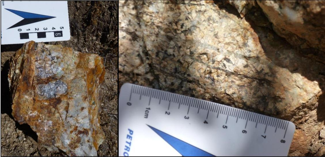
Fig. 3.8.- Estructura de cuarzo sulfuros en caja de monzo-diorita.
