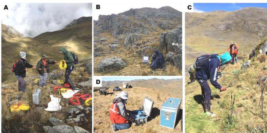
**Fig. 7.5.-** Trabajos de campo de polarización Inducida. A) Personal de apoyo realizando el tendido de cable en las líneas geofísicas. B) Personal geofísico operando el equipo Receptor GDD. C) Personal de apoyo realizando la instalación de las varillas de acero utilizadas para la inyección de corriente. D) Personal geofísico operando el equipo Trasmisor GDD
