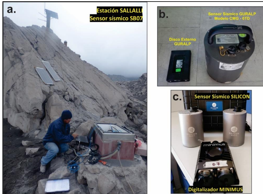
Figura 3.8. a. Estación multiparamétrica ubicada en el sector de Sallalli, b. Sensor sísmico integrado de banda ancha GURALP y c. Sensor sísmico de banda ancha SILICON AUDIO y digitalizador MINIMUS.
